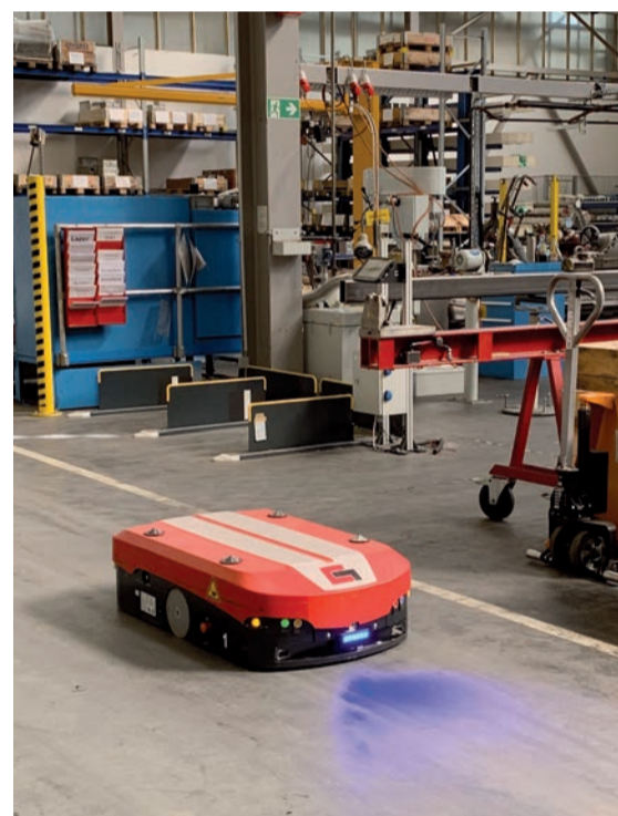
Due laser scanner montati a bordo contribuiscono a indirizzare l'AGV: il mezzo non ostacola i percorsi dell'uomo e nemmeno i ritmi del magazzino, ma si adegua in piena sicurezza
