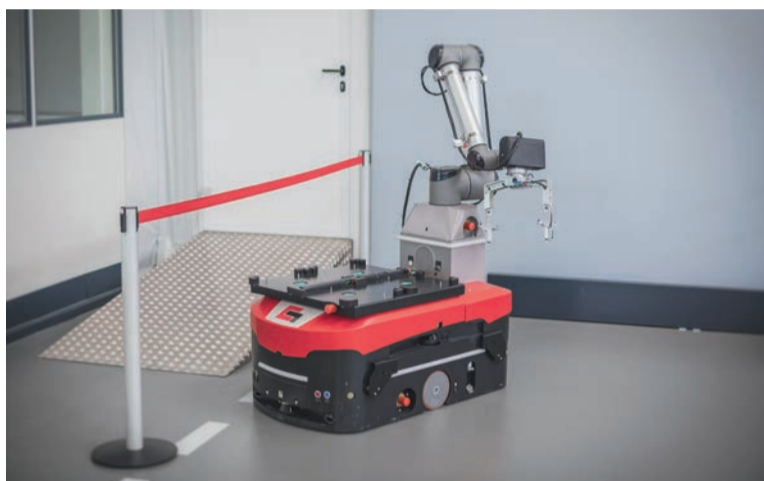
Mobile Robot MR10S può gestire pesi fino a 10 kg al polso e raggiungere una distanza di 1,3 metri con una precisione di posizionamento estremamente elevata
