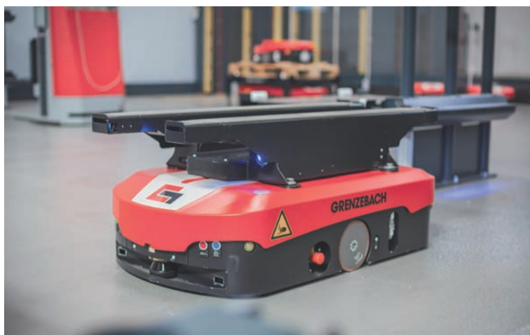
L'AGV di Grenzebach è completamente automatico, può lavorare 24 ore su 24 (al netto dei tempi di ricarica) ed è in grado di trasportare fino a 1.200 chilogrammi di peso a una velocità di 1,5 metri al secondo
